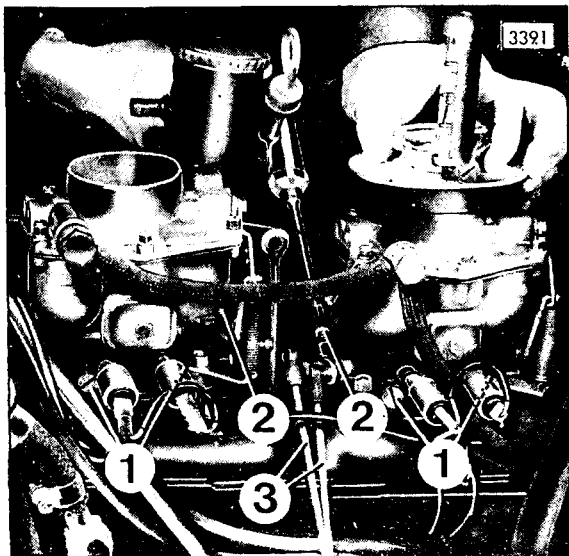
Leerlauf einstellen Régler le ralenti Idling adjustment Fig. 115
