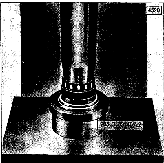
Fig. 16 Innenring des Vierpunktlagers abpressen Extraire la bague intérieure du palier quatre points Pressing off the inner race of the four-point bearing
