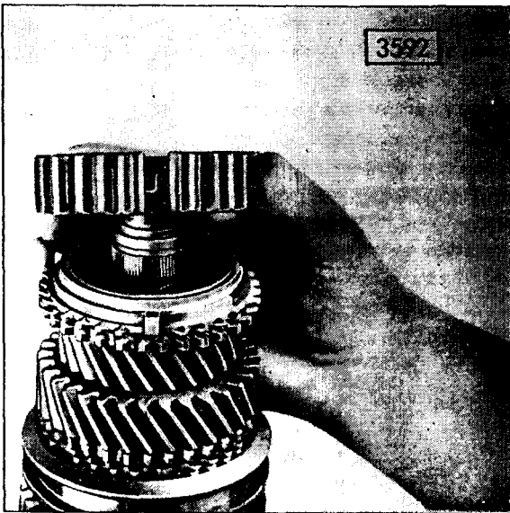
Synchronkörper für 4. u. 5. Gang aufpressen Emmancher le corps de synchronisation pour les 4ème et 5ème vitesses Pressing on the synchronizer hub for 4th-speed and 5th-speed gear
